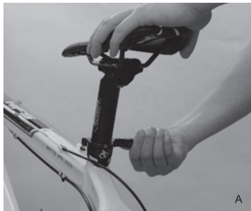
▲用手把快拆柄扳開，扳離座管的方向，即為「打開」鬆脫的狀態。
