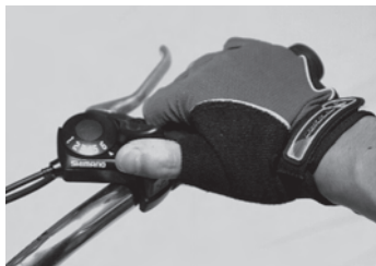
▲ 拇指式 基本款變速車常用，前後推即可變換檔位。
