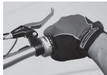
▲ Grip Shift 旋轉式 以SRAM為代表，握住旋轉變速。
