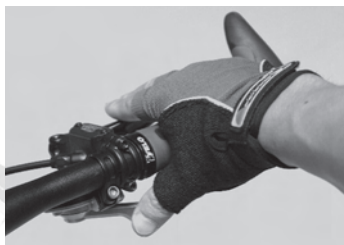
▲ Rapidfire 算盤式 中高價位車種常用(SHIMANO)，變速桿進、退檔各為單獨撥桿。
