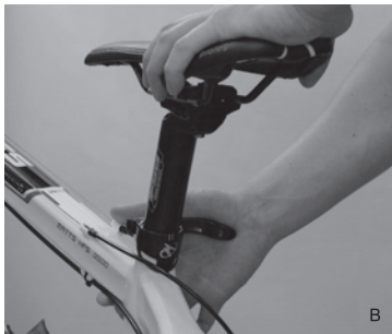
▲將快拆柄扳回壓入，逼近座管的方向，進入「鎖緊」的狀態。
